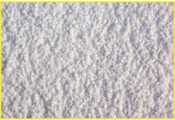
Piana zamknięto-komórkowa Plixxent Plixxool SF640100 \lambda_d=0,023 \text{ W/(m}^2\text{K)}
