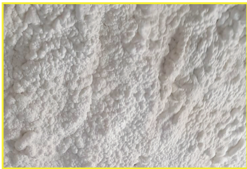
Piana otwarto-komórkowa a Plixxent Plixxool SF640090 \lambda_d=0,037 \text{ W/(m}^2\text{K)}
