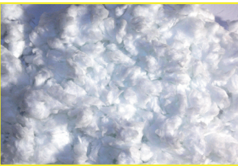
Granulaty wełny Supafil® Knauf Insulation \lambda_d=0,034-0,045 \text{ W/(m}^2\text{K)}
